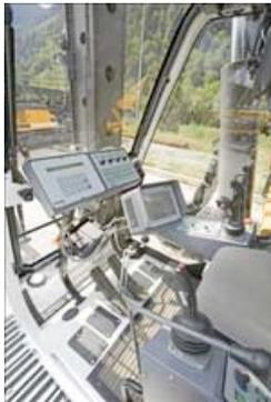
Die OPC-fähigen Steuerungen in den Kabinen liefern alle relevanten Krandaten in Echtzeit auf jedes herstellerunabhängige SCADA-System in der Leitwarte des Güterumschlagplatzes.
